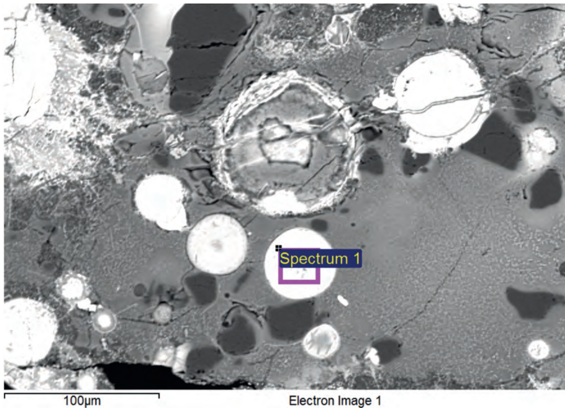
Abb. 28 REM-Aufnahme von korrodierten Arsenkupfereinschlüssen: Spektrum 1 zeigt 0,9% FeO; 93,8% CuO; 3,4% \text{As}_2\text{O}_3 und 2,9% PbO (M. Mehofer, VIAS)
